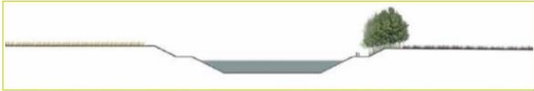
Figure 9 : Profil en travers déblai
