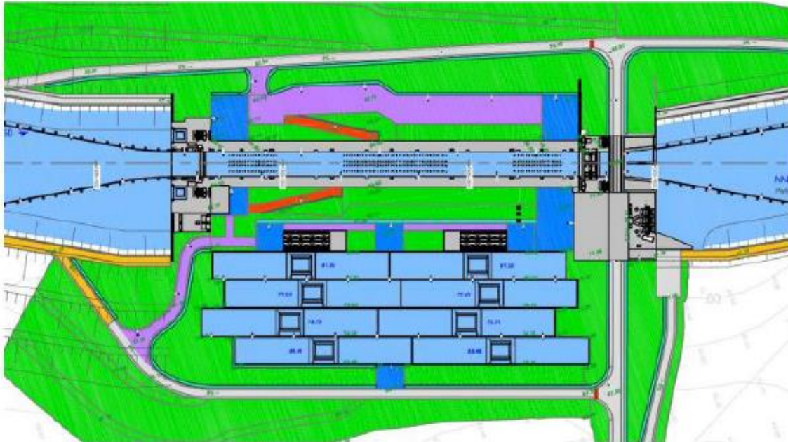
Figure 30 : Plan masse de l'écluse de Marquion-Bourlon
